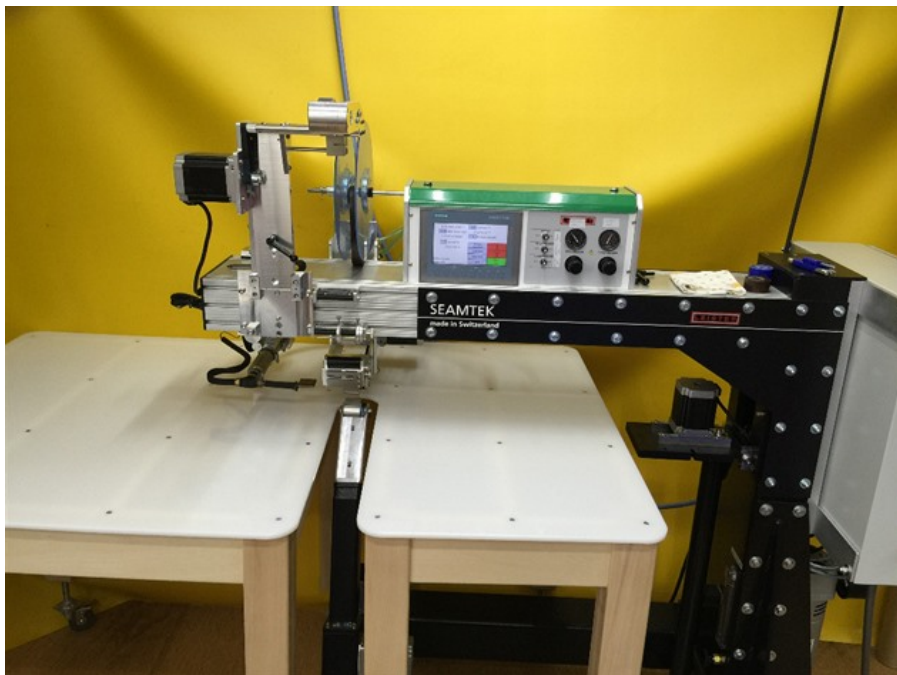
Precizní svařování plachet snadno zvládají speciální stroje | foto: SEAMTEK 36 / EBK ERET BERNARD, s.r.o.
